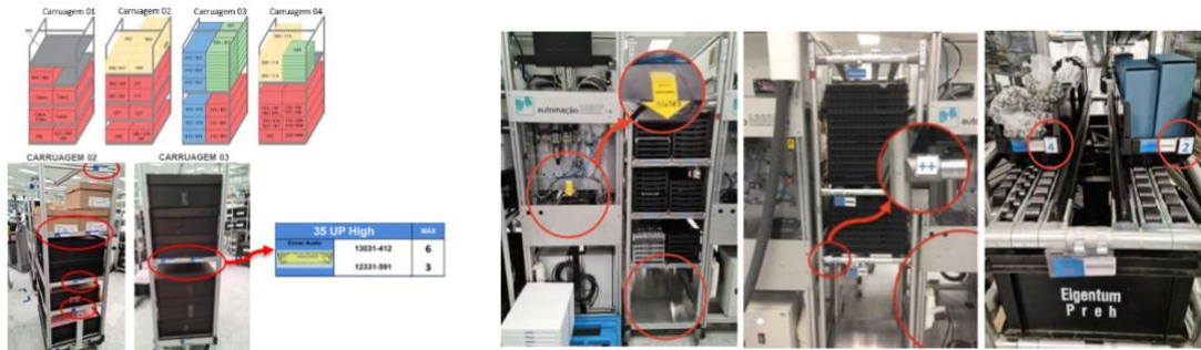
Figura 30 - Identificação dos materiais e quantidades no comboio e na linha de montagem
