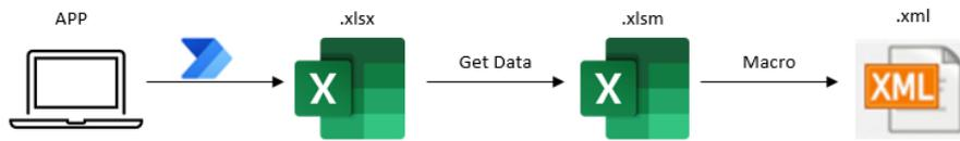
Figura 4.27: Diagrama da 1ª solução para obter o ficheiro .xml final preenchido
