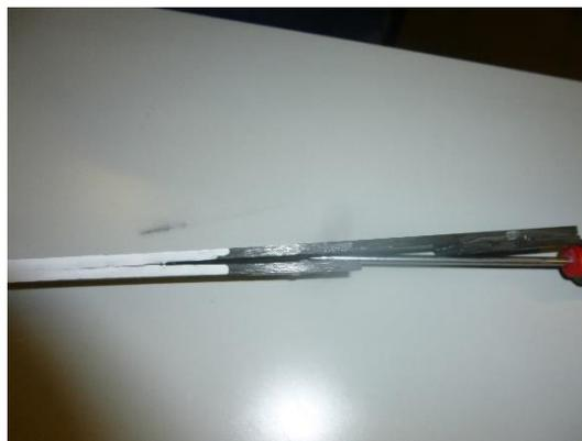
Figura 96 – Iniciação manual da fenda através de chave de fendas.
