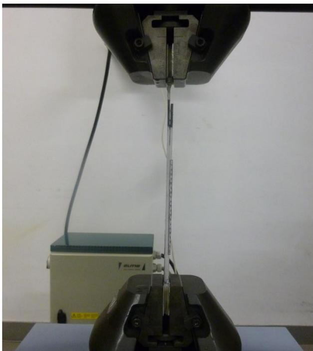
Figura 99 – Provete colocado no *gripper* da máquina de ensaios.
