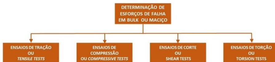
Figura 19 - Determinação de esforços de falha em maciço ou bulk (elaboração própria).
