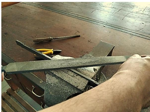
Figura 94 - Remoção do excesso de adesivo com lima.
