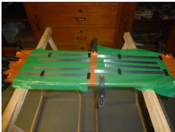
Figura 85 – Localização dos espaçadores nos provetes.
