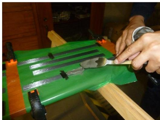
Figura 88 - Adesivo Araldite® AV138 a ser depositado.
