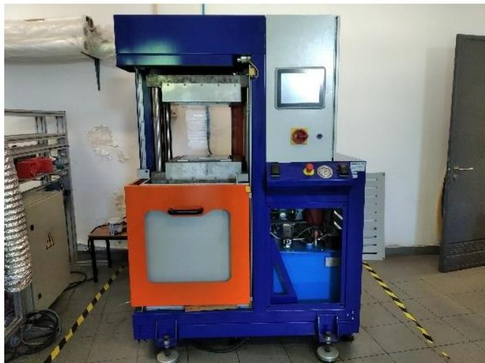
Figura 76 - Prensa para curar placas CFRP.
