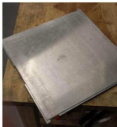
Figura 78 - placa de CFRP entre chapas de aço.
