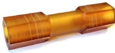
Figura 31 - Provete para ensaio à torção [70].
