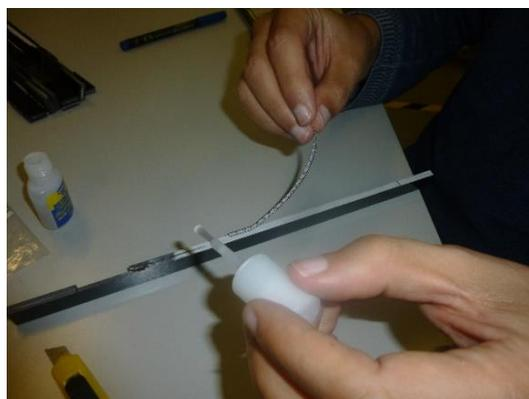
Figura 97 - Colar a escala na lateral do provete após iniciação de fenda.
