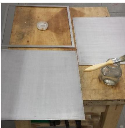
Figura 77 - Aplicação de desmoldante.
