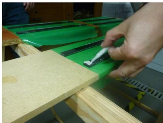
Figura 92 - Colagem das chapas de alumínio.
