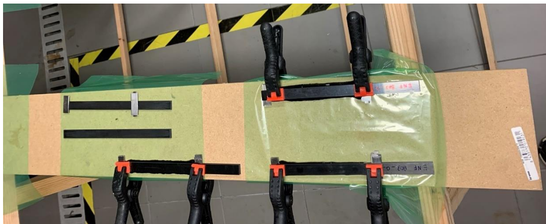
Figura 127 - Provetes finalizados para cura
