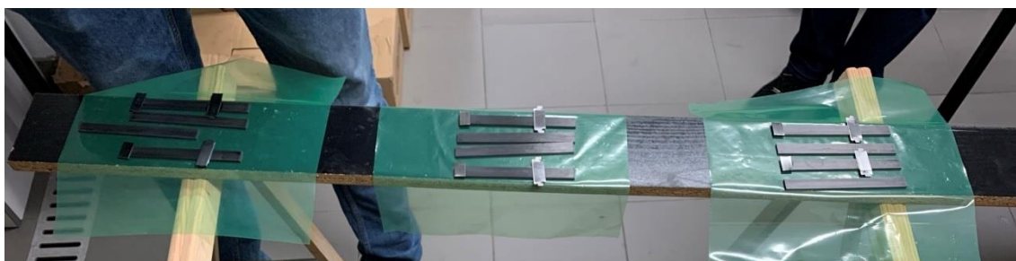
Figura 98 - Alinhamento dos aderentes para aplicação de adesivo
