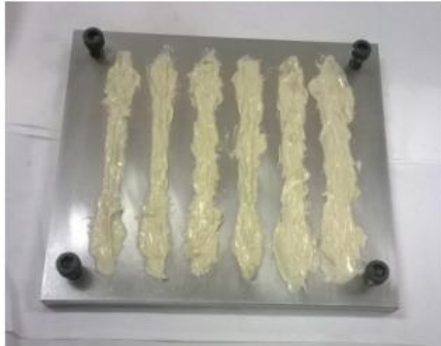
Figura 18 - Placa inferior de molde para vazamento [6]
