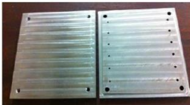
Figura 38 – Moldes para criação de provetes Bulk
