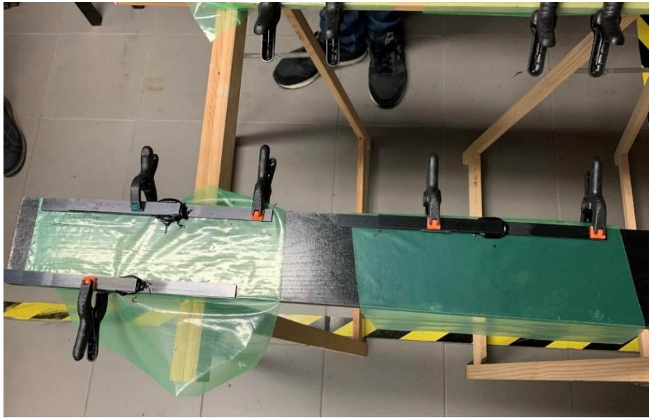
Figura 149 – Colagem dos provetes JSS
