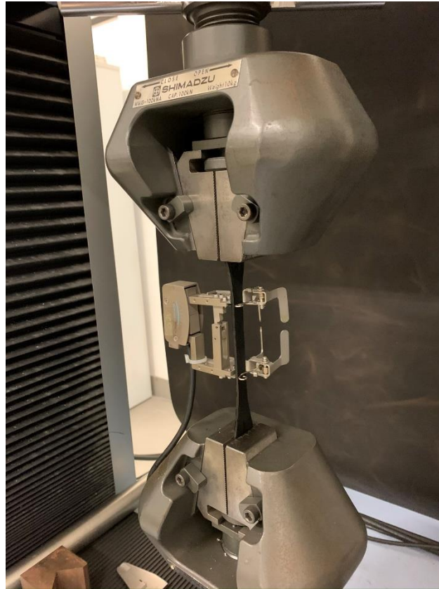
Figura 52 – Setup do ensaio com extensómetro mecânico
