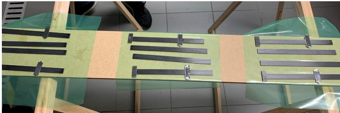
Figura 125 - Aderentes ENF posicionados para colagem
