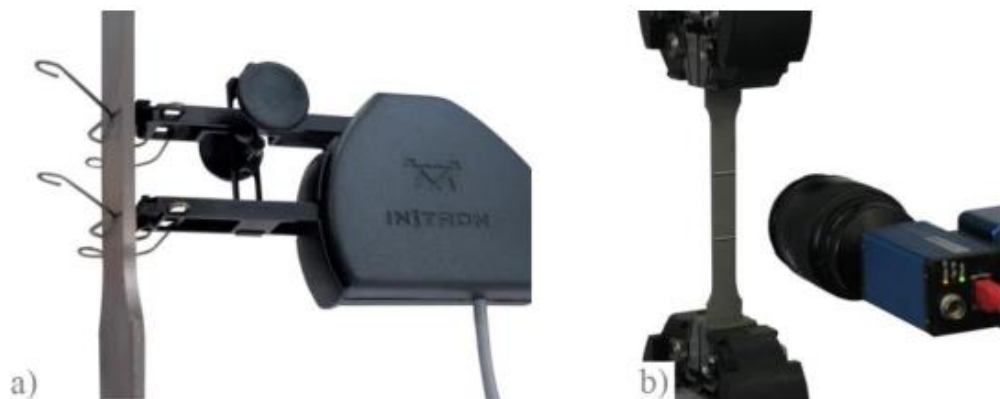
Figura 20 - Extensómetros usados no ensaio de tração [7] a) Extensómetro mecânico b) Extensómetro ótico
