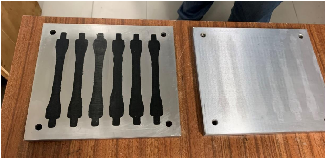
Figura 50 - Abertura do molde com adesivo curado
