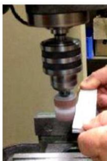
Figura 77 - Remoção da rebarba e adesivo em excesso
