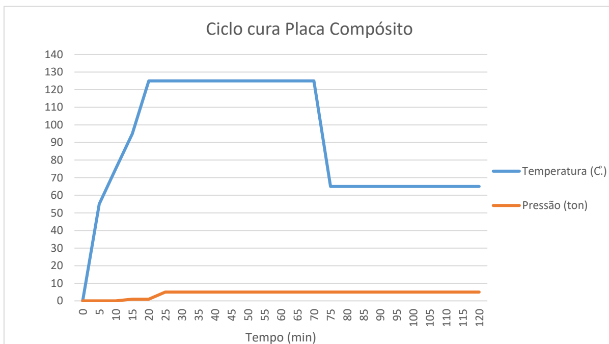
Figura 72 – Programa usado na cura da placa
