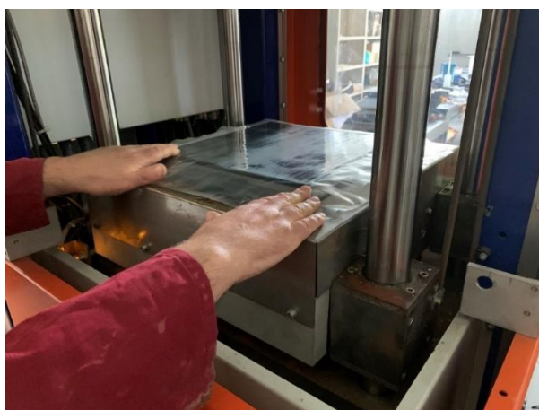
Figura 71 – Colocação da placa na prensa
