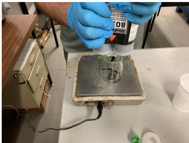
Figura 45 - Adição do adesivo para pesagem
