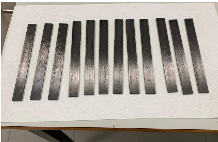
Figura 95 - Aderentes após lixagem e limpeza
