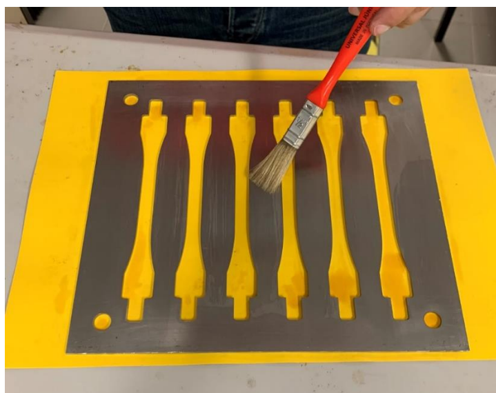
Figura 44 – Aplicação de desmoldante na placa intermédia/matriz
