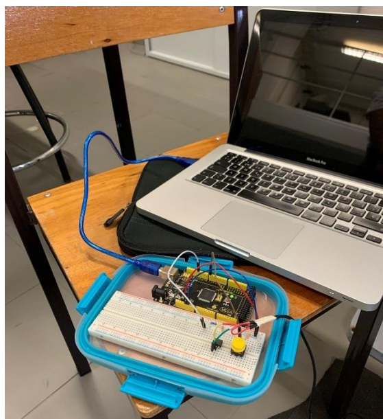
Figura 108 - Equipamento para captura automática de imagens
