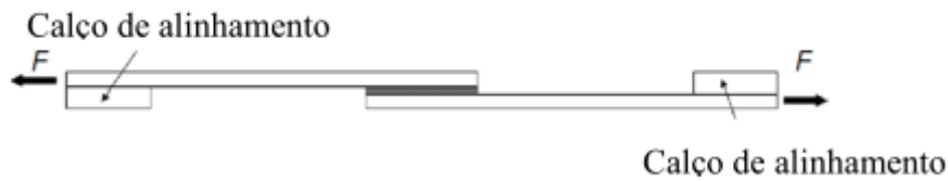
Figura 23 - Junta adesiva de sobreposição [7]
