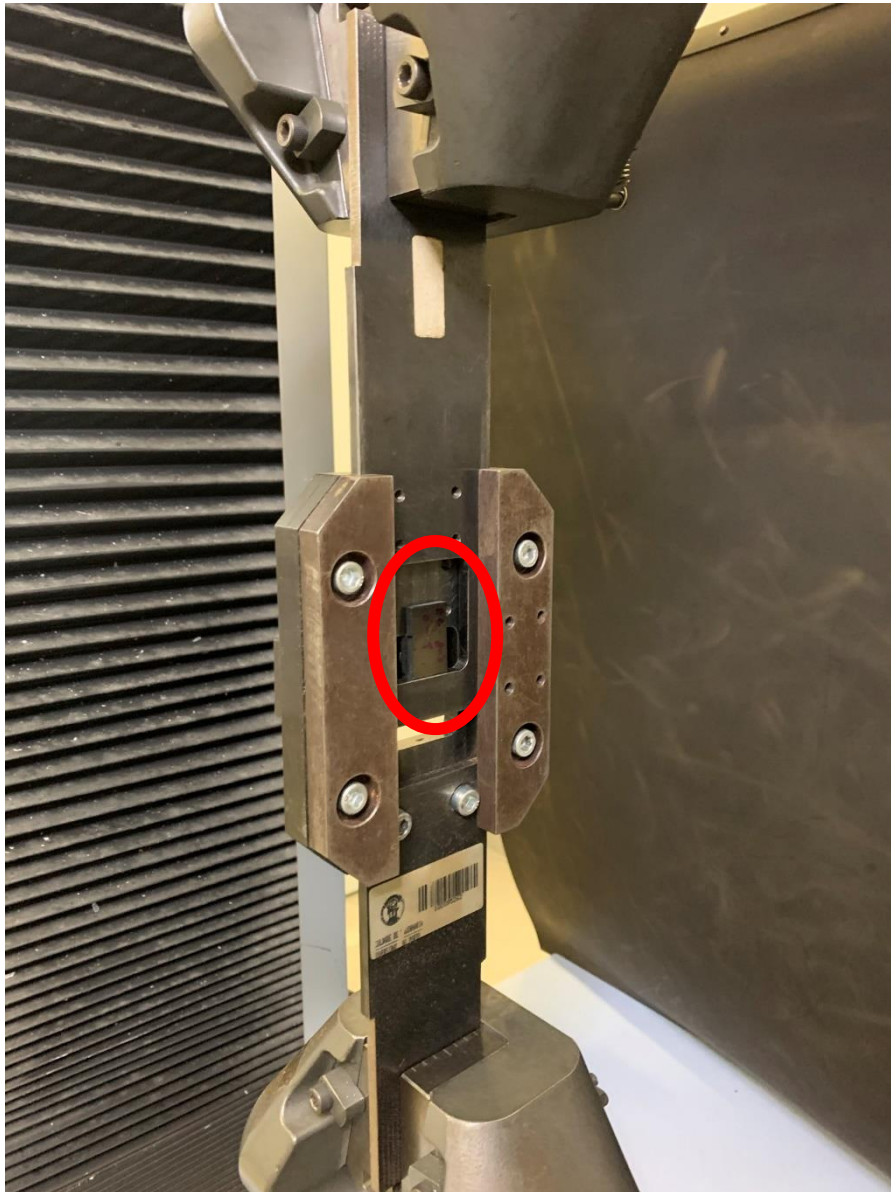
Figura 78 - Colocação do provete para ensaio block shear na ferramenta
