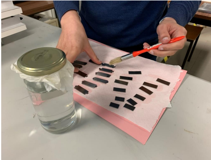
Figura 96 - Aplicação de desmoldante aos componentes metálicos
