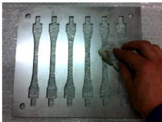
Figura 40 – Limpeza com acetona do molde
