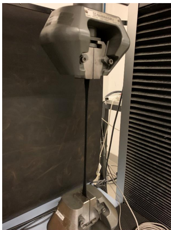
Figura 54 - Provette durante o ensaio momentos antes da rotura
