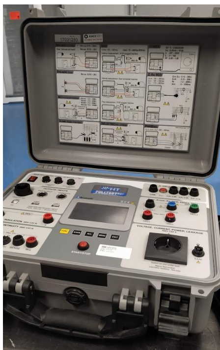
Figura 12 Equipamento utilizado para ensaios de tensão e resistência
