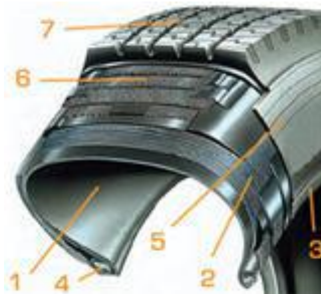
Figura 3 – Constituição do pneu [14]
