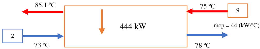
Figura 4.54 Permutador responsável pela troca de calor entre um ramo da corrente 9 e a corrente 2 e correntes a este associadas
