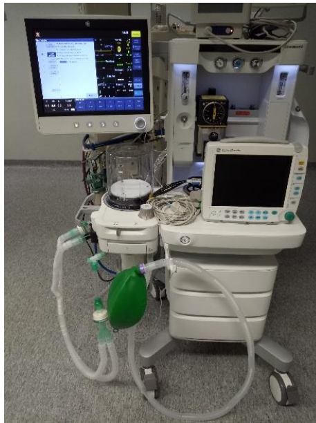
Figura 34- Ventilador de BO Aisys Carestation Datex-Ohmeda, presente no Serviço de Cirurgia do HPH.
