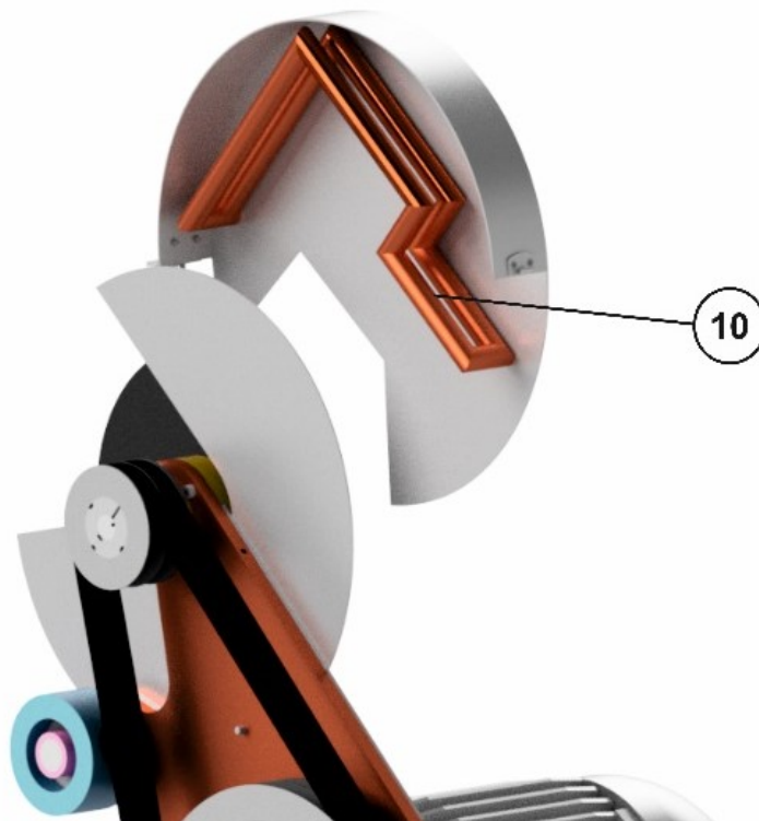
Figura 62 - Abertura da proteção do disco com tubos de cobre
