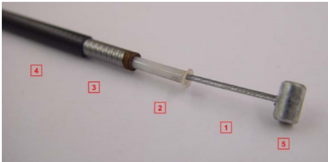
Figura 7 - Constituição de um cabo de comando [25]
