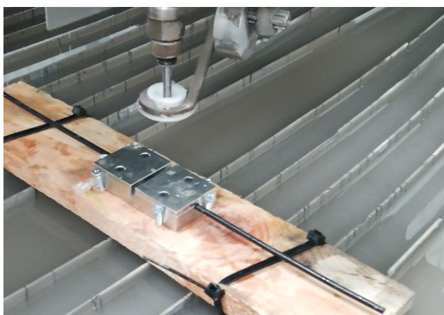
Figura 33 - Ensaio de corte com jato de água
