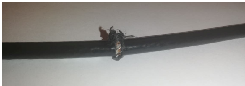
Figura 35 - Deformação do revestimento em espiral braided
