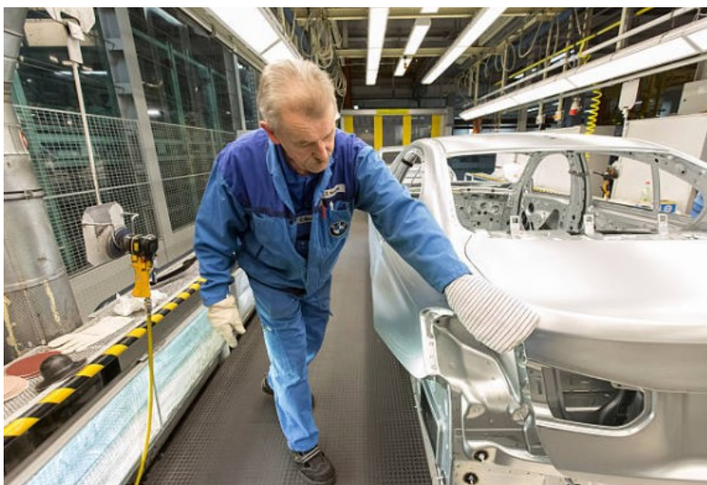
Figura 11 - Verificação da carroçaria de um BMW Série 3 [37]
