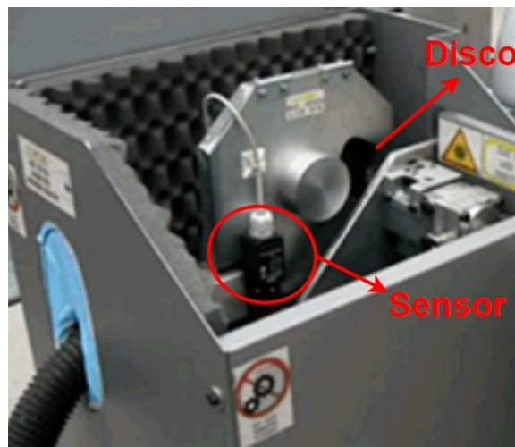
Figura 22 - Sistema de avanço do disco do equipamento existente
