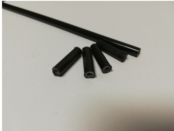
Figura 40 - Amostras cortadas em disco de diamante
