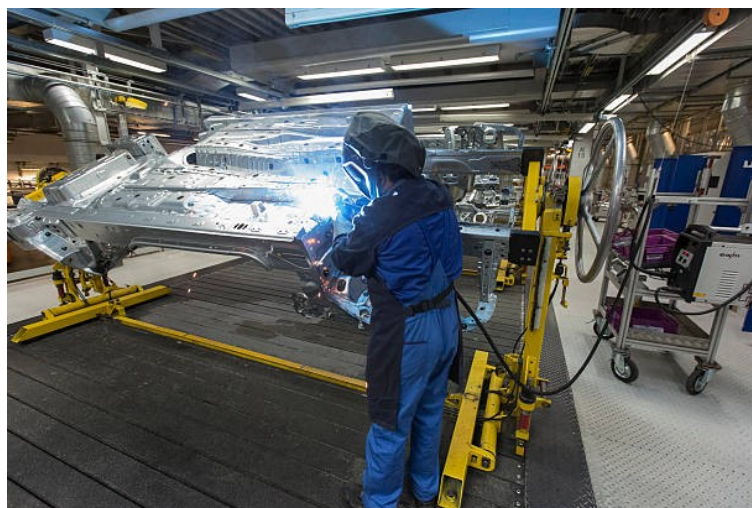
Figura 12 - Soldadura de um chassi de um BMW Série 3 [37]
