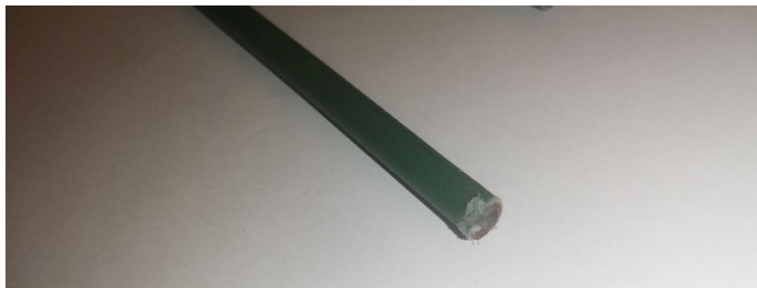
Figura 38 - Oxidação da espiral
