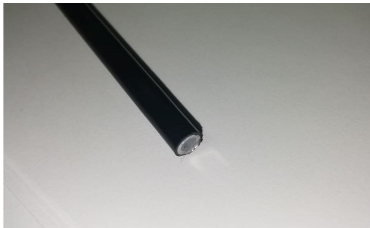
Figura 19 - Exemplo de corte com qualidade realizado em espiral
