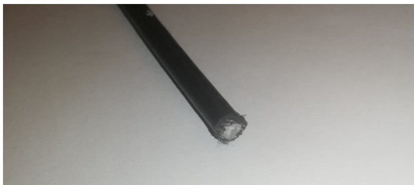
Figura 36 - Corte com obstrução do tubo interior em espiral braided
