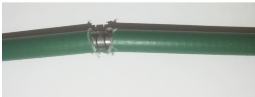
Figura 34 - Corte incompleto em espiral laminada sem tubo interior
