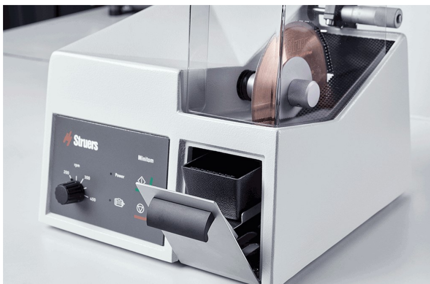
Figura 39 - Minitom – equipamento utilizado para corte das amostras [54]
