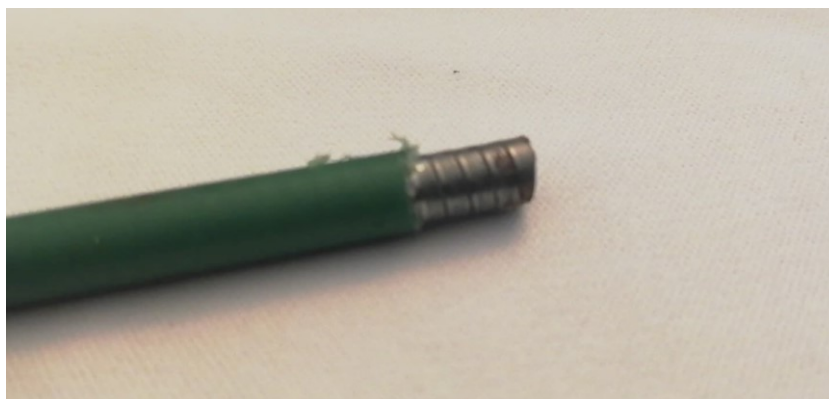
Figura 28 - Espiral laminada sem tubo interior
