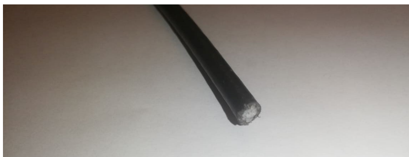
Figura 37 - Corte com obstrução do tubo interior em espiral armada
