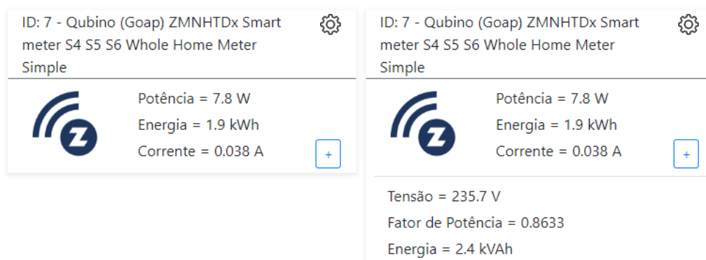
Figura 4.17: Elemento referente a um Smart Meter não expandido, à esquerda, e elemento referente a um Smart Meter expandido
