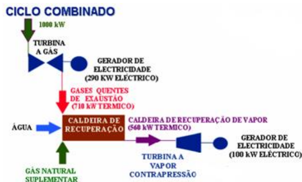
Figura 15 Processo e equipamento utilizado no ciclo combinado [3]
